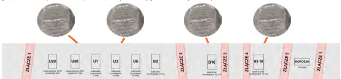
Rys. 4. Schemat uszkodzeń na badanej taśmie z pokazanymi realnymi zdjęciami wybranych uszkodzeń Fig. 4. Diagram of damage on the tested belt with real photos of selected damages shown
