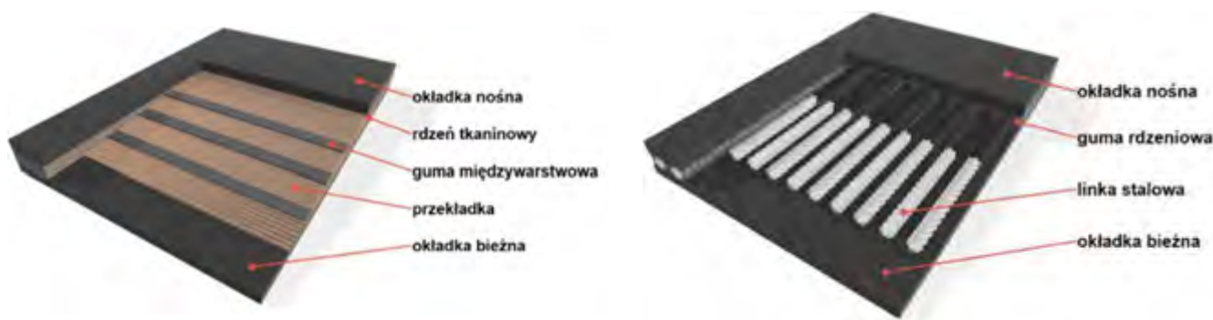
Rys. 1. Schemat taśmy przenośnikowej (a) z rdzeniem tkaninowym (b) z rdzeniem z linkami stalowymi Fig. 1. Diagram of a conveyor belt (a) with a textile core (b) with a steel cord core
